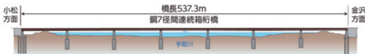
図-4 側面図（川北能美大橋）
