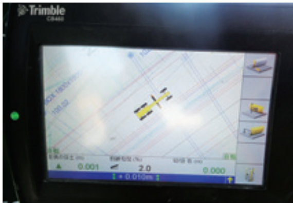
MC グレーダー（自社機械）施工時のモニター画像
