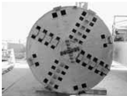
掘削機面版 掘削地盤に適合した開口(率)
