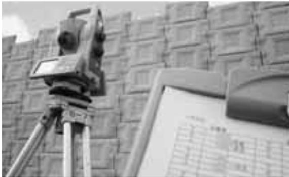
壁面ノンプリズムトータルステーションによる変位測定
